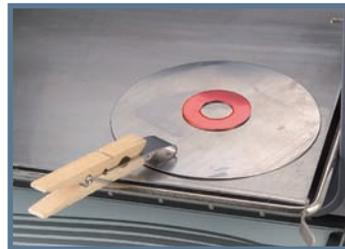
6. Anschließend wiederholst du Schritt 1. und 2. auf der Rückseite des Schmuckstücks. Rückseite mit Schleifklotz säubern und mit Farbschmelzpulver bestreuen.
